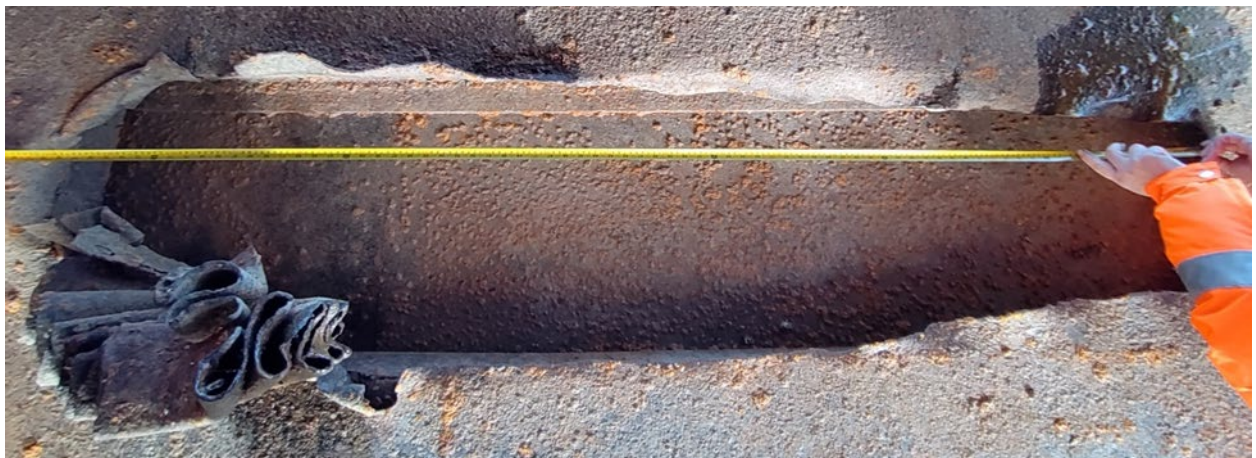
Слика 5.1.3.4. Велико оштећење, позиционирано испод прамчаног спремишта
