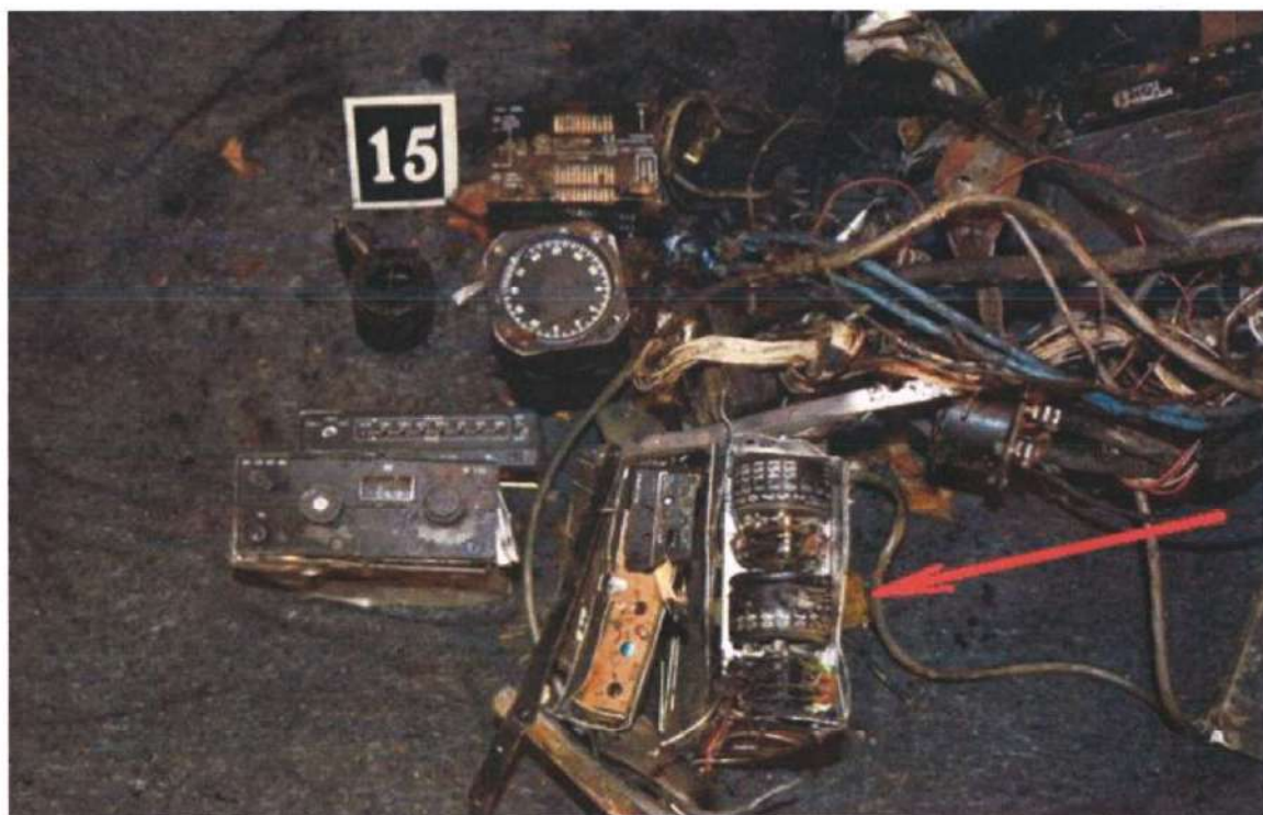
Slika broj 6.13: Deo kabine aviona sa više instalacija i uređaja (ILS-lokalajzer 108.70MHz)
